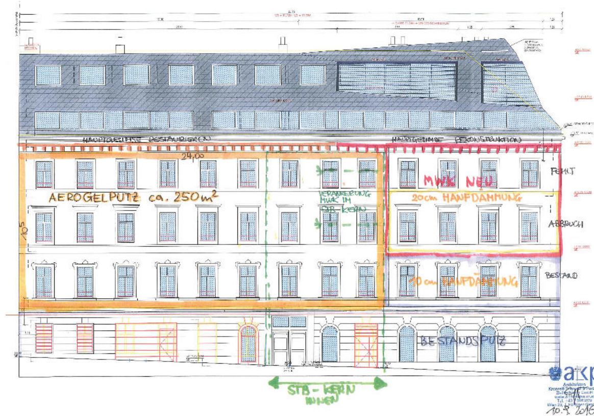
ANSICHT DENGLERGASSE KONZEPT WÄRMEDÄMMUNG
